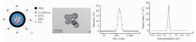
图 1 载 DTX 的叶酸和聚多巴胺修饰的 CA-PLGA 纳米粒子的表征
