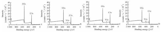
图 2 未载药纳米粒子的 XPS 谱图
