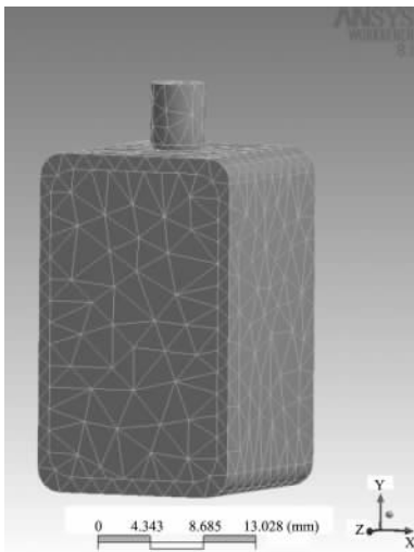
图2 Cawood II, Zarb III型牙槽嵴种植体复合有限元模型(III类骨质)
