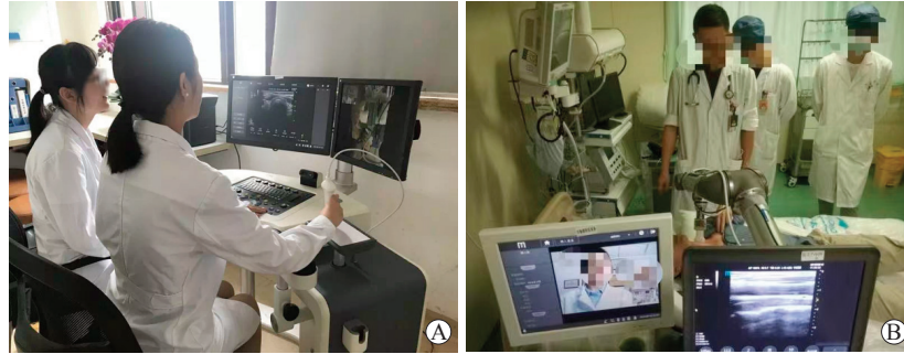
图1 基于5G的远程超声机器人系统
